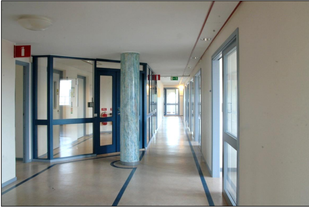
Kontorskorrridor. Planen är utförd med två parallella korridorer, på ömse sidor om ett centralt trapphus. Innanför fasadens fönsterband är kontors- och sammanträdesrum förlagda.
